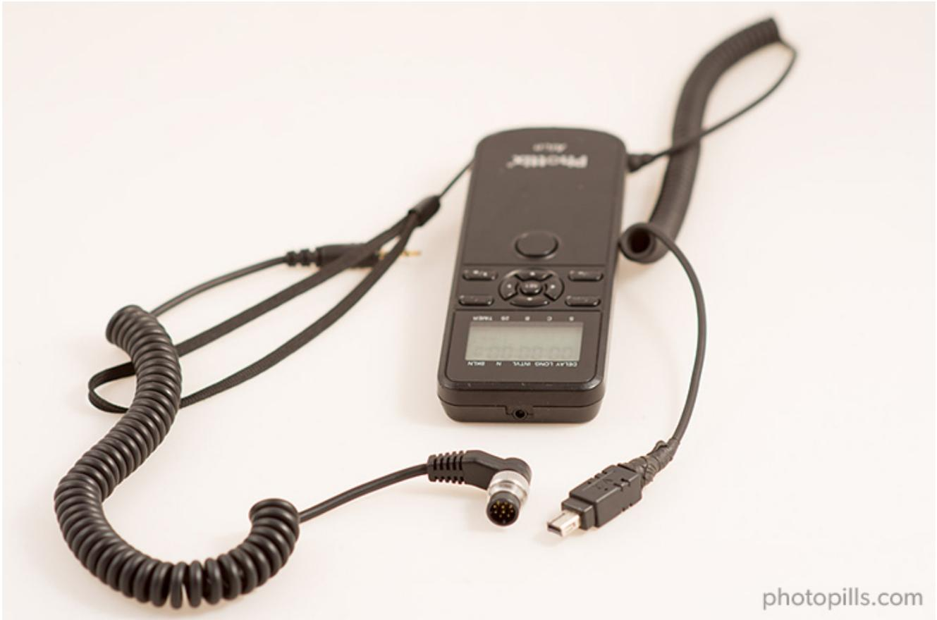
El intervalómetro que utilizo: el **Phottix AION**.
