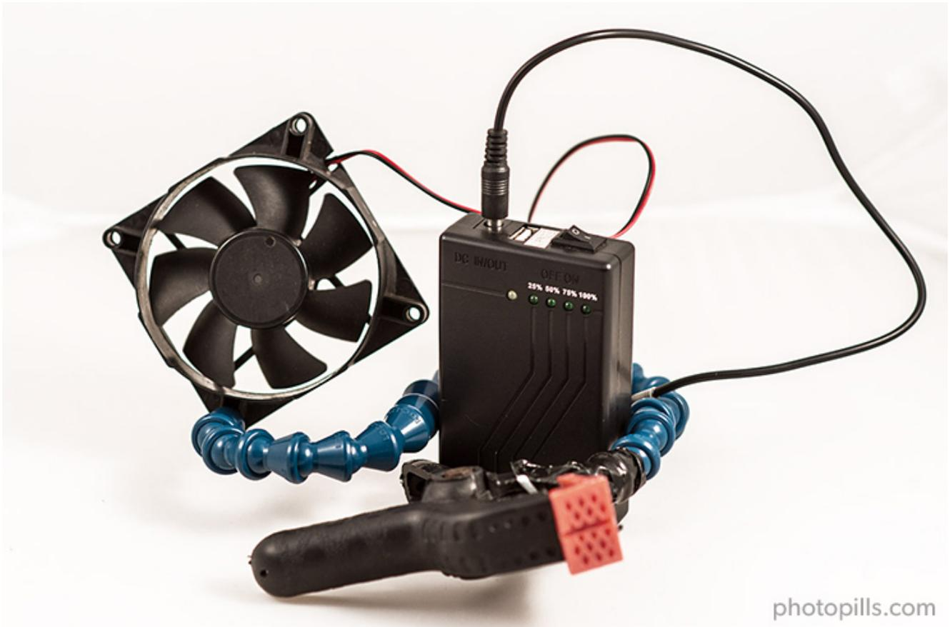
El sistema que utilizo: un ventilador de PC conectado a una batería portátil.
