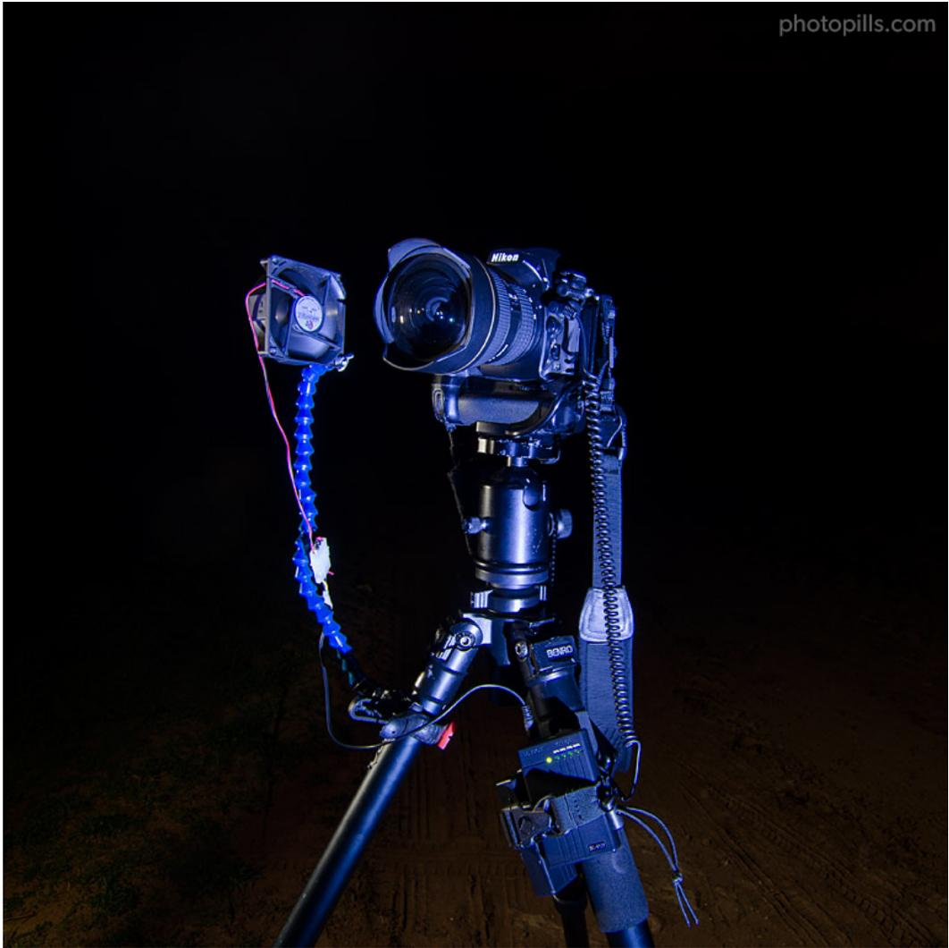
El ventilador de PC y la batería enganchados al equipo.
